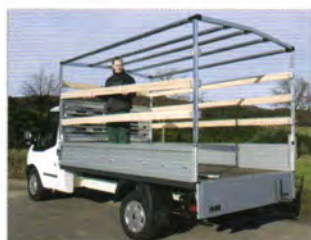
Einbau der Einstecklatten
