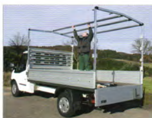
Einbau der Spriegelrohre
